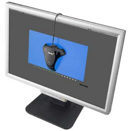
Abb. 11.3 Ein Gerät wie der Spyder von Datacolor (Abbildung) oder ColorMunki von X-Rite hilft, den Monitor zu kalibrieren. (Foto: Datacolor)
